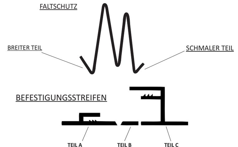
Schneiden Sie vor Beginn der Montage den Streifen mit einem Stanley-Messer in die Teile A, B und C. Entsorgen Sie den Teil B.
